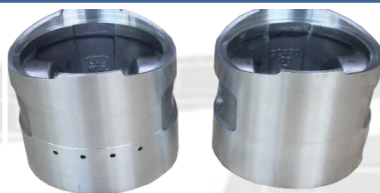
鑽油孔 - 鑽側邊油孔機
