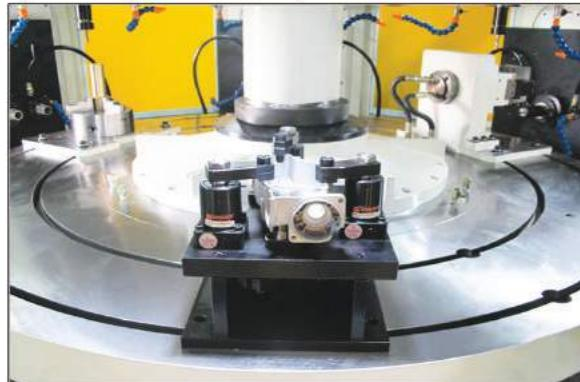
治具盤面易於更換、夾持治具快速定位，
