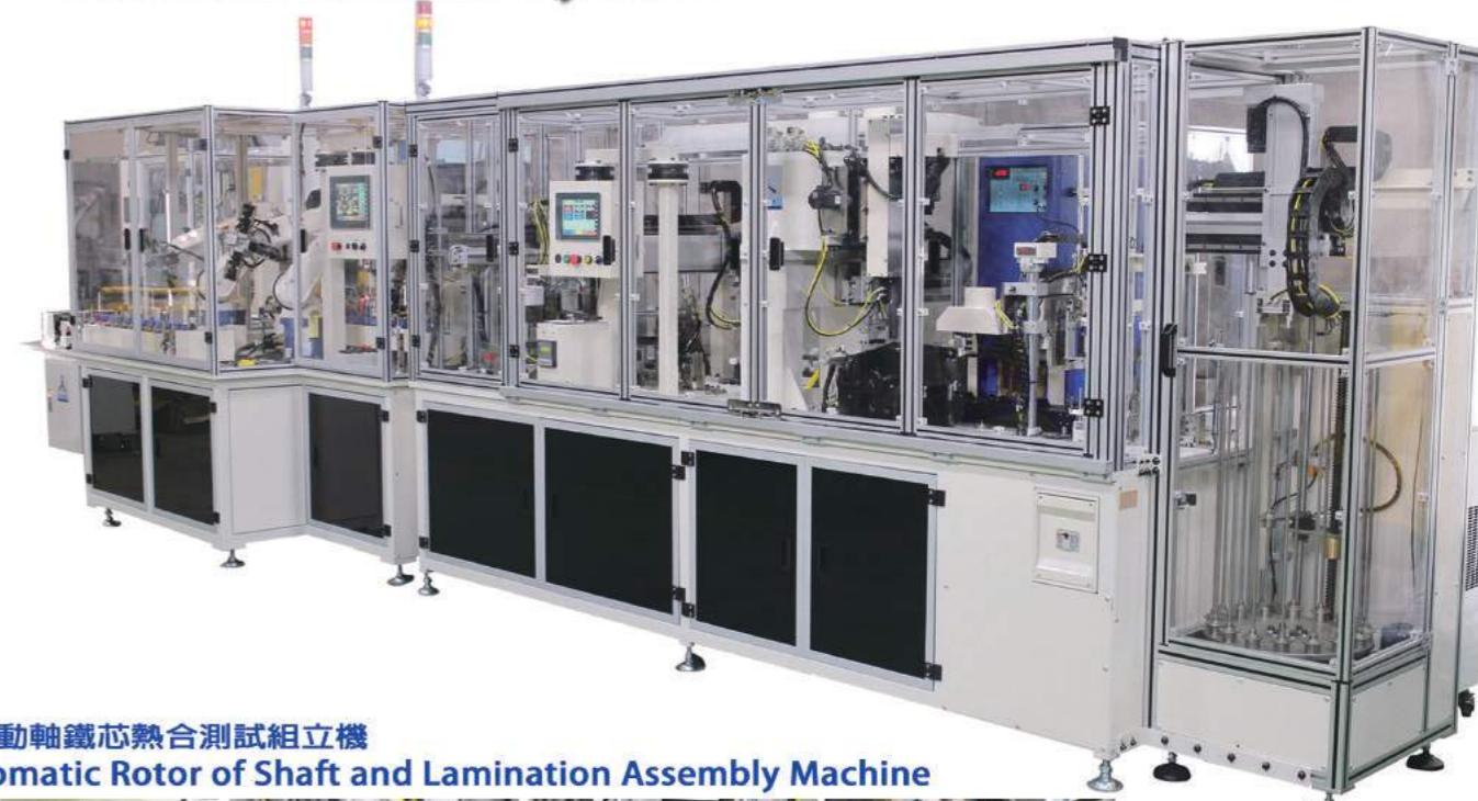
全自動軸鐵芯熱合測試組立機
