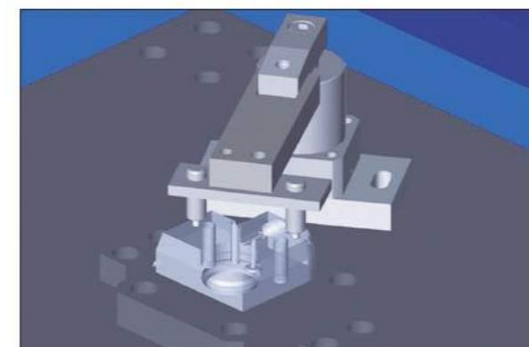
LVDT檢測工件孔的深度
