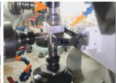
三方向主軸 Tri-direction spindles
