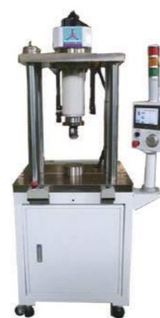
全自動鐵心塗膠磁鐵組合機
