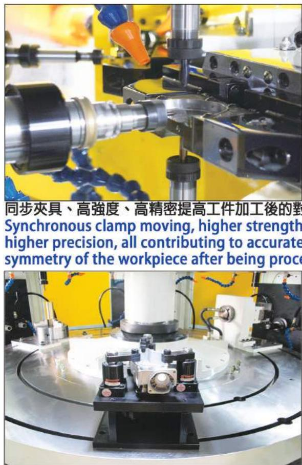
同步夾具、高強度、高精密提高工件加工後的對稱度
