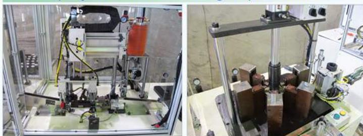
◆塗膠 Epoxy Instillation ◆磁鐵組入 Magnet press fit
